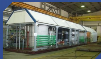
Станция комплексной электрокоагуляционной подготовки воды «Водопад-400» для Харасавейского ГКМ
