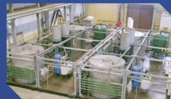
Станция комплексной электрокоагуляционной подготовки воды «Водопад-400» для Харасавейского ГКМ
